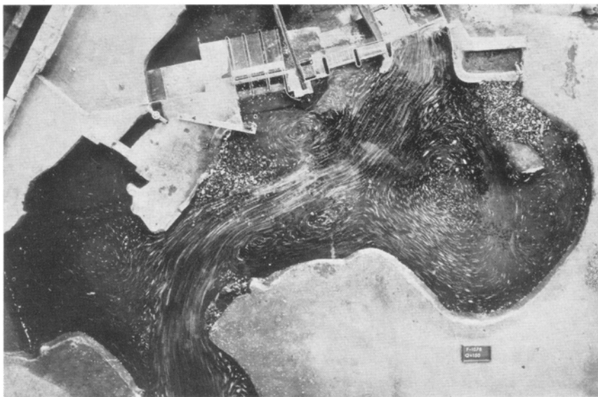
Strømningsforholdene i Indre basseng etter at de verste hvirlene var fjernet. (Fig. 5.)
