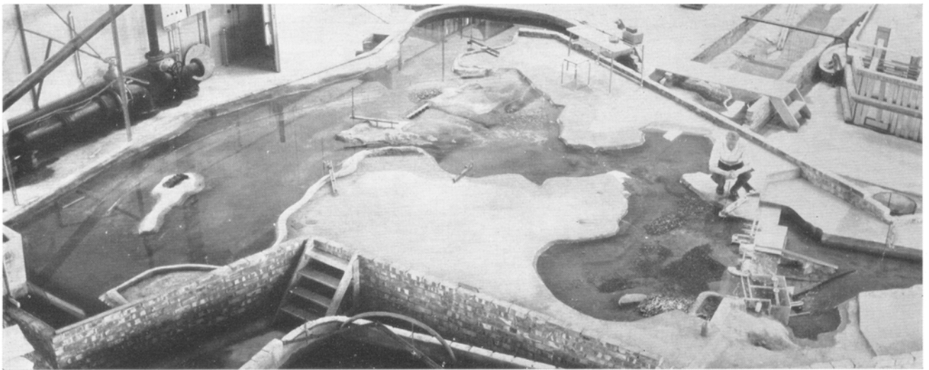
Modell av Hunsfossen. Dam, kraftstasjon og sliperi m. v. ble bygget av gjennomsiktig plast. Forøvrig består modellen hovedsakelig av betong og fyllmasser. (Fig. 3)
