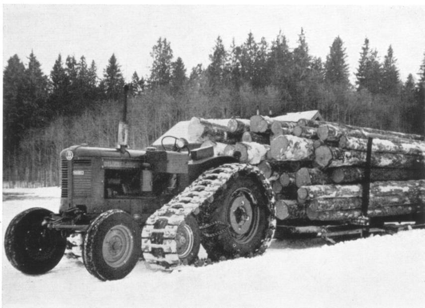
Halvbelte-traktor med 12 kubikkmeters tømmerlass.
