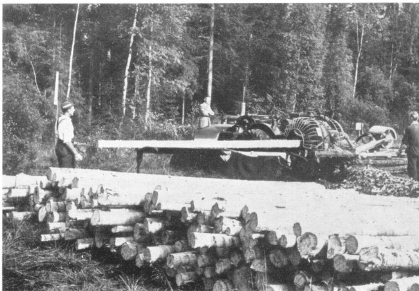
Maskinell barking i skogen. Kapasitet: Ca. 100 kubikkmeter pr. dag.
