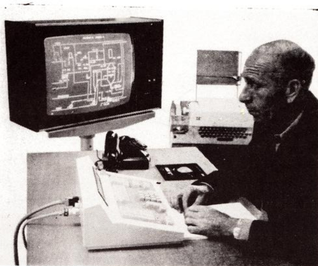
Kombinasjonen fargeskjerm, funksjonstastatur og rulleball er en effektiv og god måte for operatørene å kommunisere med prosessen på.
